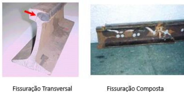
Figura 21 - Anomalias transversais (adaptado de Coimbra, 2008)
