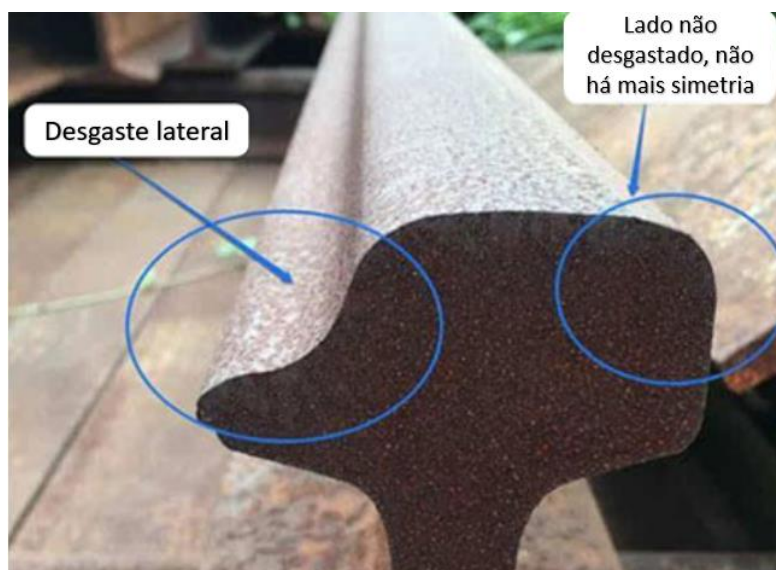
Figura 23 - Desgaste lateral em trilho (AGICO Rail website)
